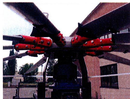
Particolare attacco pala per diametri 5-6-7-8 metri
